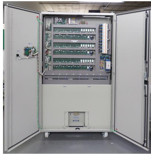
Figura 1: Vista frontal do banco de cargas R, L, C trifásico com as portas abertas.
